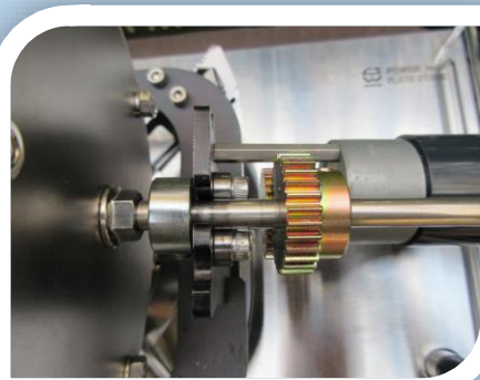
焙煎機をセット後部ギアを上下にセット。
