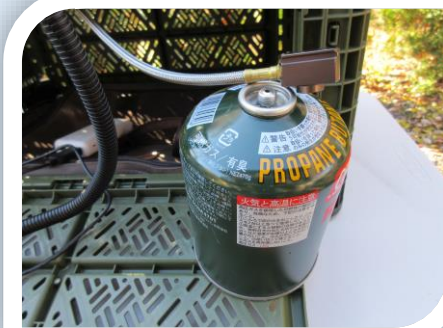
バーナー接続金具は直接ガスボンベに接続します。
