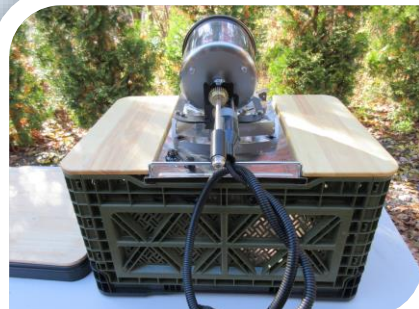
焙煎機の左右に板プレートを挟んでセット。左右の板プレートはバーナーに乗ります。
