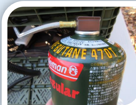
接続は強く締めてください。ボンベは立ててください。装着時・外すときは、ガスが少し出る時があります。換気、火に注意してください。
